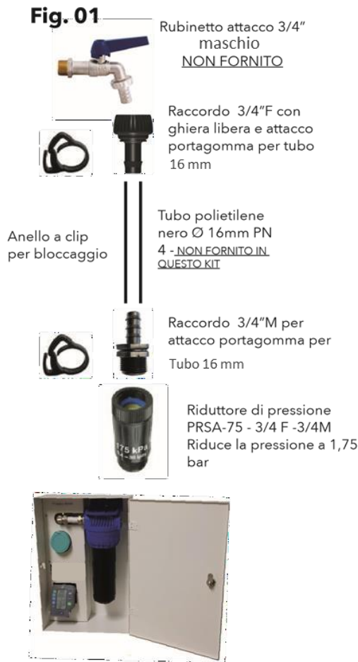
Schema collegamento rete idrica ZanzBusters 25 MINI
